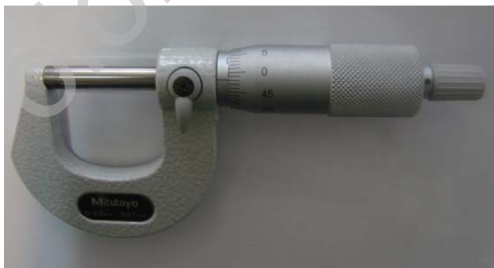
شکل (۱-۵) وجود خطای صفر در یک ریزسنج
