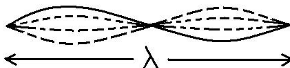
شکل (۱۰-۱) تناسب طول تار مرتعش با طول موج در امواج ساکن
