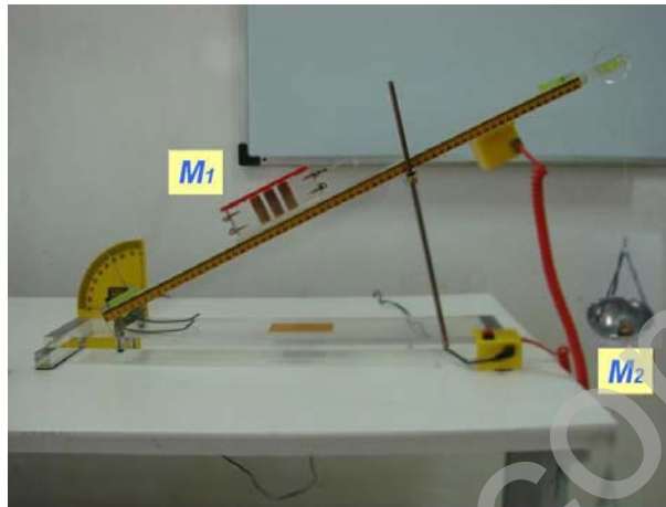
شکل (۶-۶) دستگاه سطح شیبدار با زاویه شیب ۳۰ درجه
