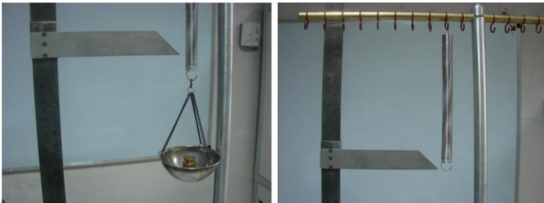
شکل (۷-۲) افزایش طول فنر بر اثر نیروی وزن کفه نگهدارنده و وزنه های درون آن
